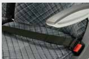
Cinto 2 pt retráctil / Retractable 2pt safety belt
