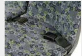
Aufrollbarer 2-Punkt-Sich- erheitsgurt / Retractable 2pt safety belt
